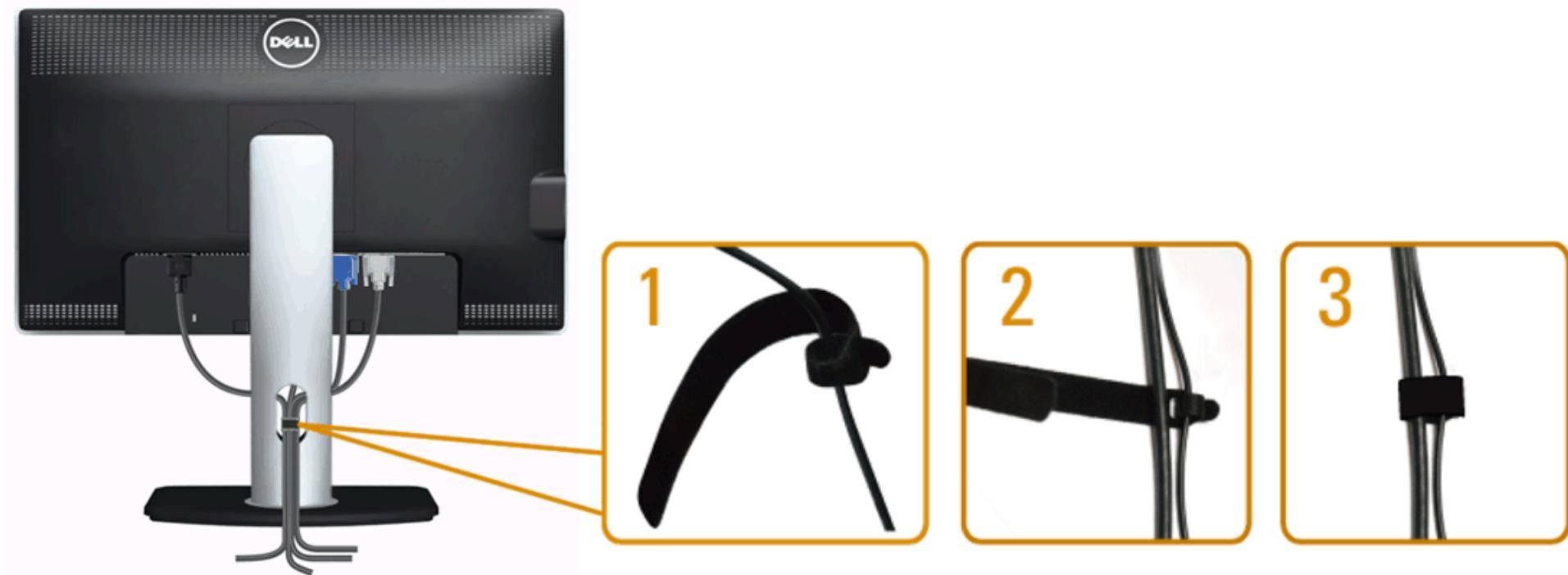
Después de conectar todos los cables necesarios al monitor y al PC, (consulte [Conectar su monitor](#) para conectar los cables), utilice la ranura de sujeción de cables para organizarlos correctamente tal y como se muestra arriba.
